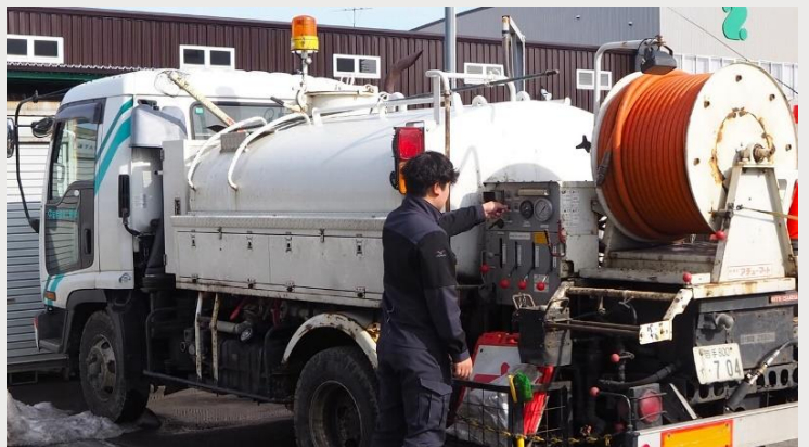
▲下水道管内の洗浄・清掃業務を行う洗浄車を点検する星さん。
